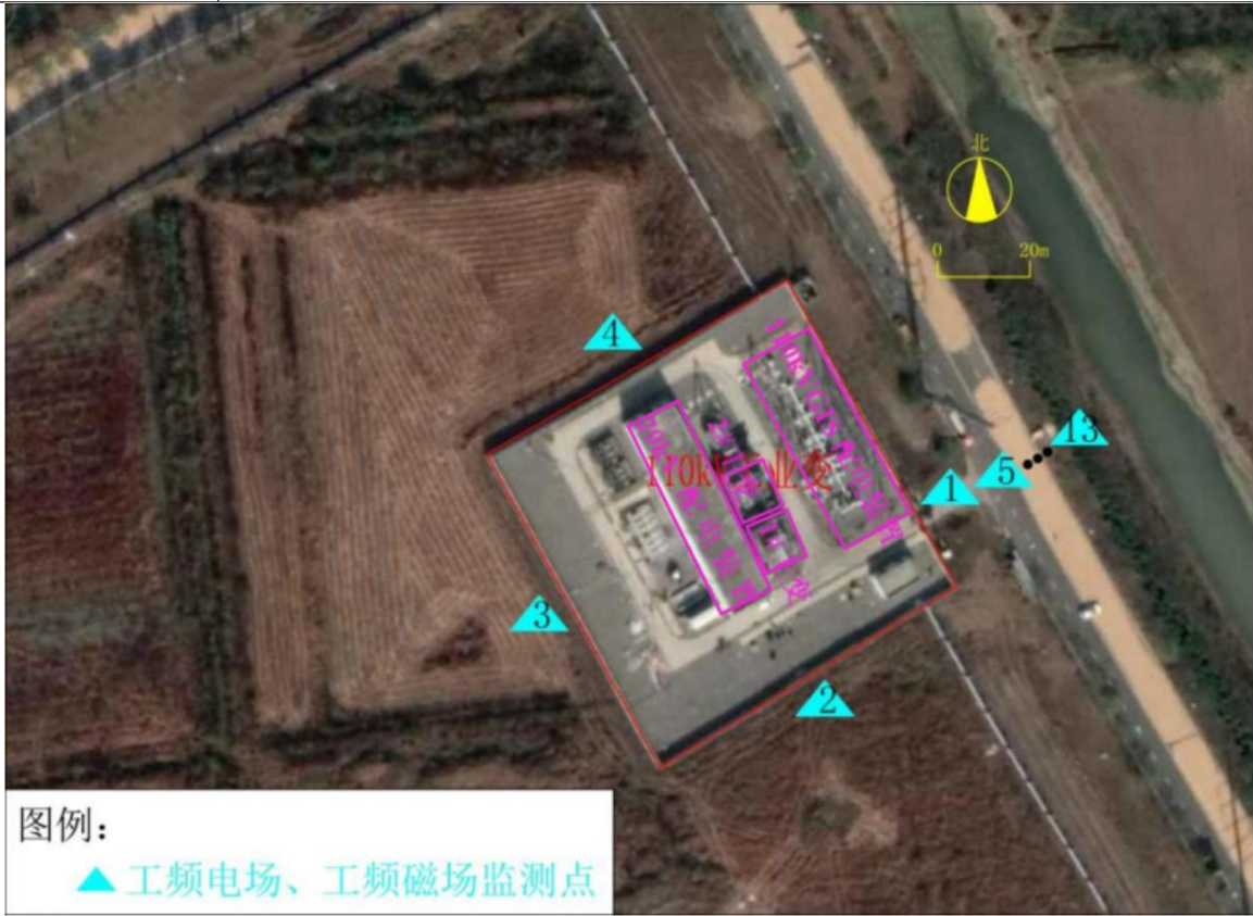
图 3-1 110kV 工业变电站（类比站）平面布置及监测点位图
